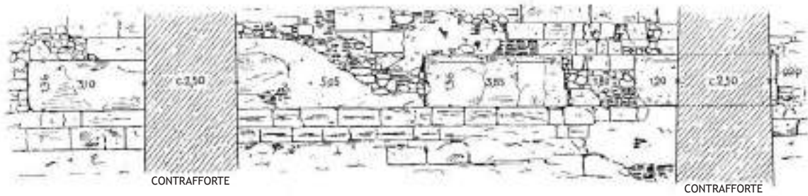
Fig. 32 - Acropoli, mura meridionali, disegno degli architravi arcaici reimpiegati (da WIEGAND 1904)
