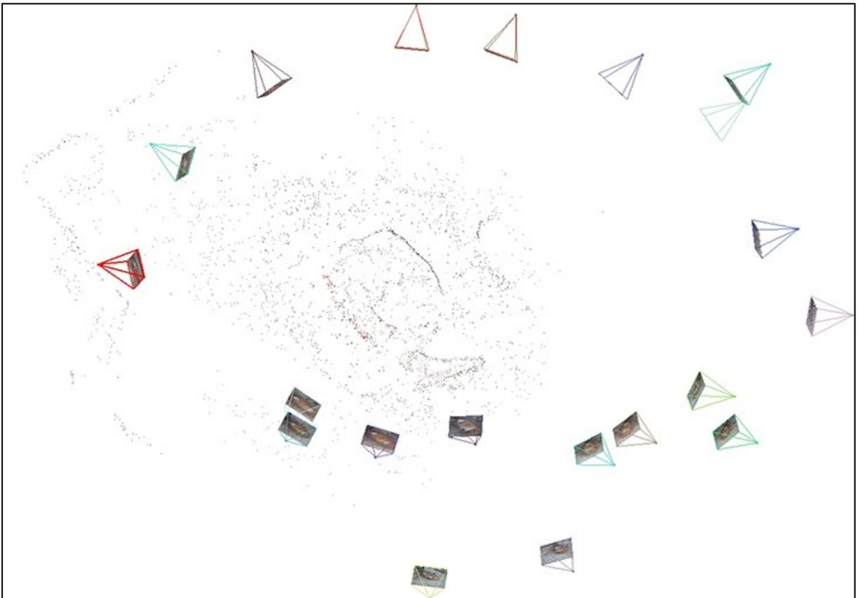
Fig. 7 - Elaborazione nuvola di punti con posizione dei punti di ripresa.
