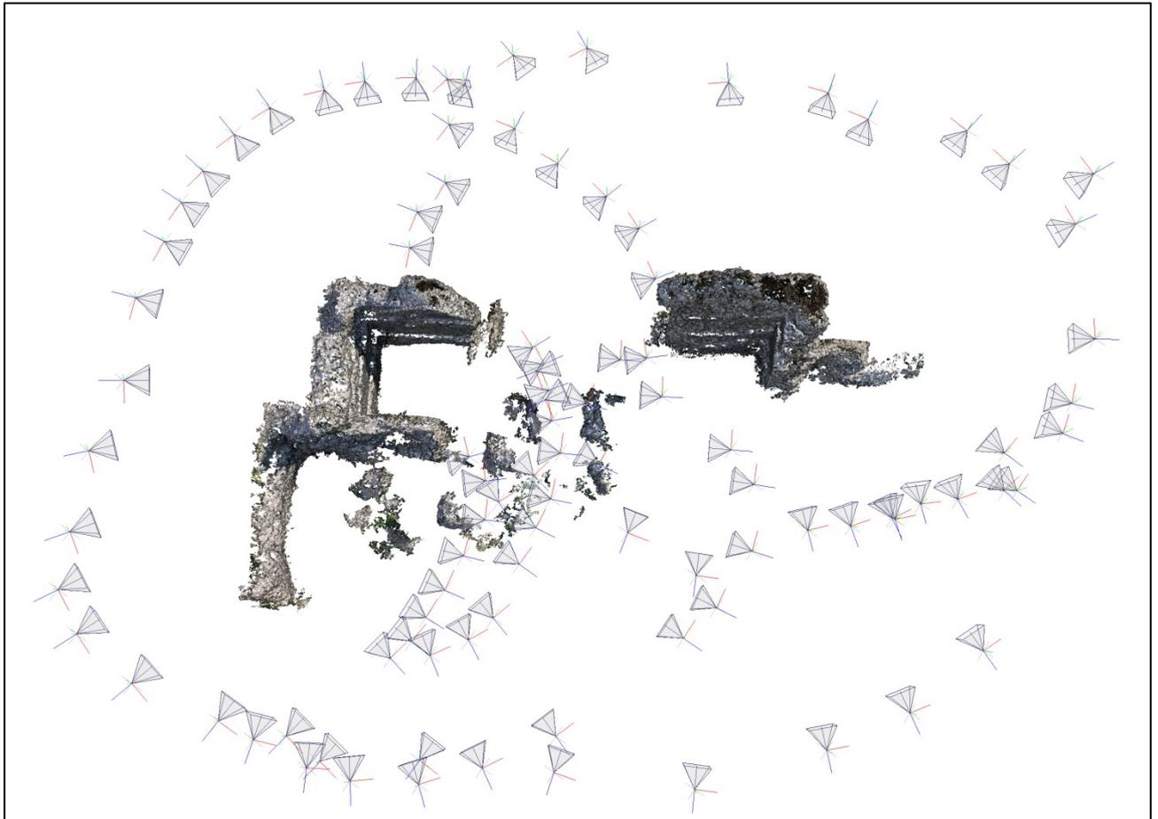
**Fig. 15 - Nuvola di punti della porta SW con posizionamento delle camere**
