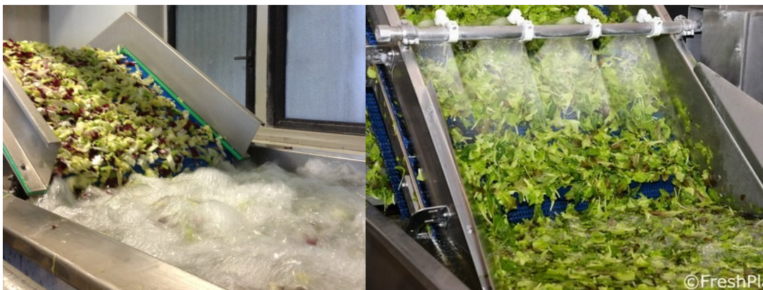
Figura 1.8 Lavaggio insalata di quarta gamma
